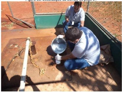
Figura 54: Coleta da amostra em frascos estéreis no poço 01
