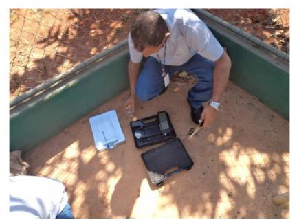
Figura 55: Medição do pH no local de coleta do poço 01 utilizando o peagâmetro
