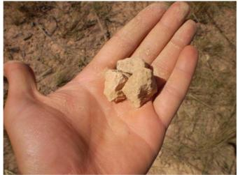
Figura 35: Presença de muitos fragmentos de rocha pelítica, inviabilizando a perfuração do solo em maiores profundidades. (Coordenadas: 203199E/ 8226297N, Projeção: UTM, Datum SIRGAS 2000, Zona 23S). Data: 11/08/2012. Foto tirada por Gabriel Franco Miranda.
