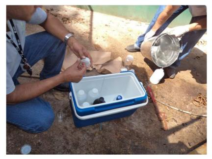
Figura 59: Coleta da amostra em frascos estéreis no poço 02
