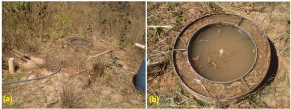
Figura 34: (a) Situação do local de realização do ensaio. (b) Vista do local de realização do ensaio pelo método dos anéis concêntricos. (Coordenadas: 203199E/ 8226297N, Projeção: UTM, Datum SIRGAS 2000, Zona 23S). Data: 11/08/2012. Foto tirada por Gabriel Franco Miranda.
